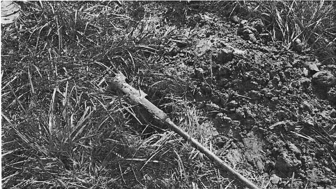
Az F3-as jelű furat 5 méteres mélységéből származó átázott talajminta
